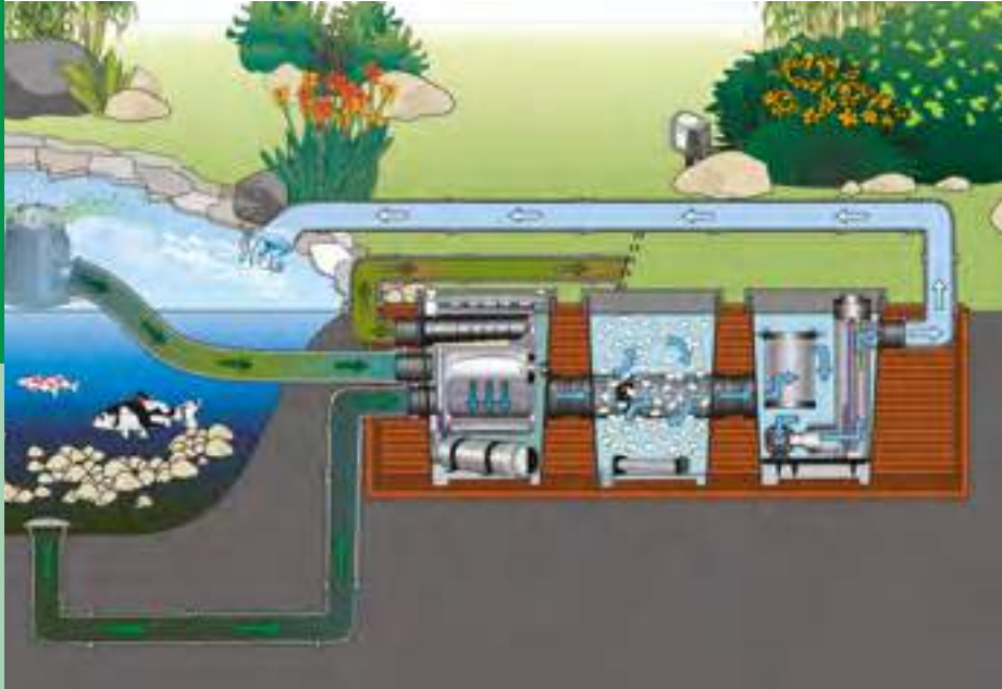
Схематическая диаграмма: модульные фильтры ProfiClear великолепно подходят для использования в прудах кои
