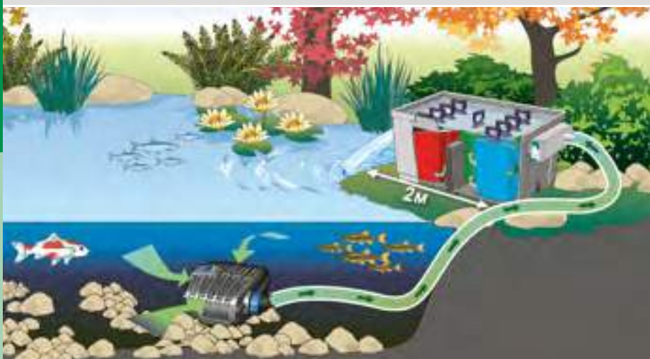
Схематическая диаграмма: BioSmart 30000 вместе с насосом для фильтров и ручьев AquaMax Eco Classic
