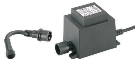
PRI.: 230V~50Hz 70VA SEC.: 12V Max: 60W
